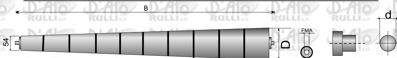
Rullo conico per curve con raggio interno di 500mm - Tubo in acciaio Ø 30
