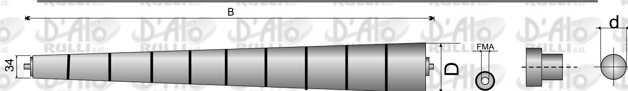
Rullo conico per curve con raggio interno di 800mm - Tubo in acciaio Ø 50
